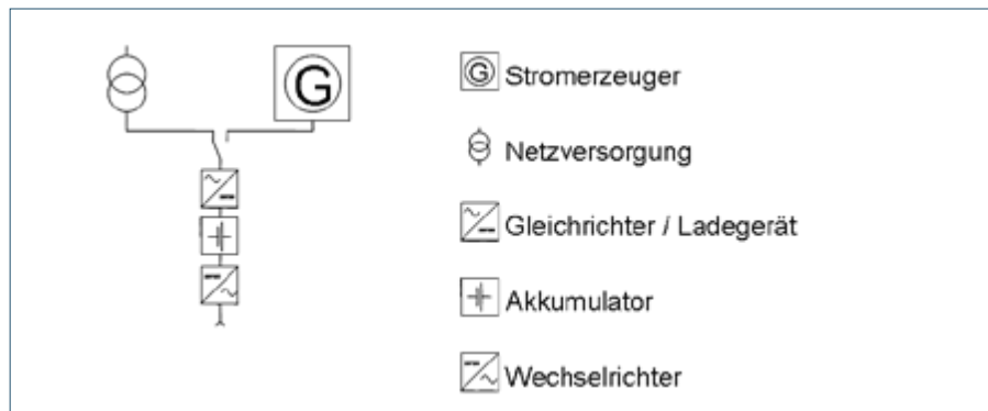
Abb. 4: USV – Anlage mit Stromerzeugerbetrieb
